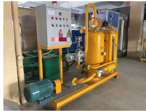
图3 蒸汽回收系统样机实物图
